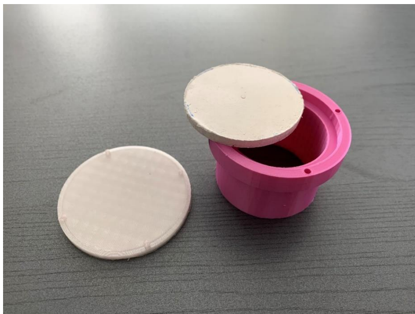
Rys. 26. Zaprojektowany i wykonany uchwyt na drukarce 3D do wieloizotopowego źródła kalibracyjnego Źródło: opracowanie własne
