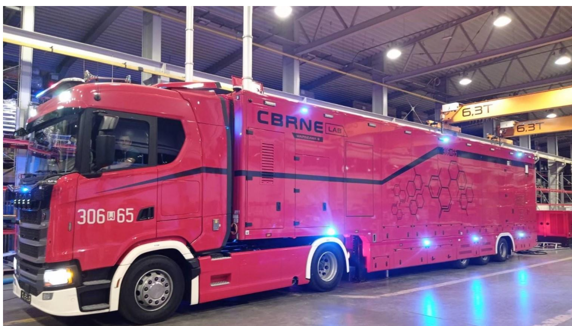
Rys. 4. Mobilne laboratorium CBRNE służące do sprawowania monitoringu radiacyjnego środowiska w Polsce Źródło: opracowanie na podstawie [65]
